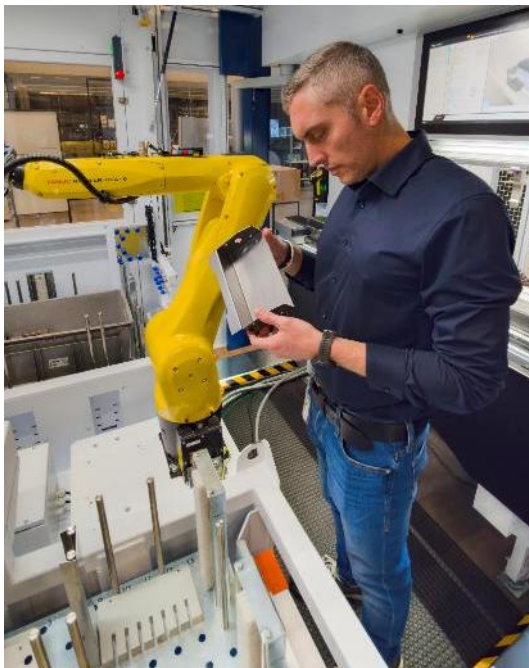
Bild 2) „In der Zelle“: Marc Unger, Operations Manager bei Blechnext, überprüft das mithilfe des Roboterarms in der Biegezelle automatisch abkantete Blechteil. Bild: ©Blechnext
